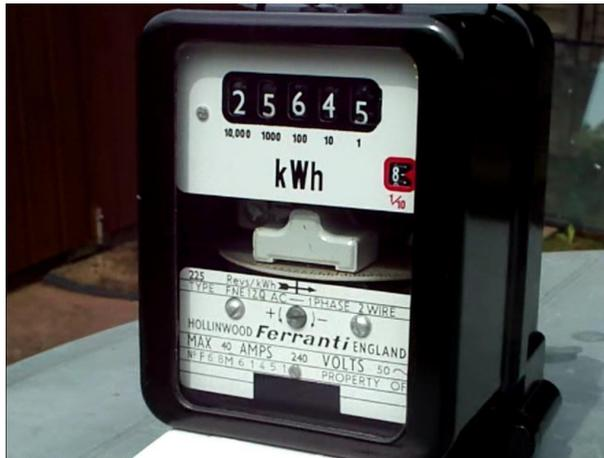
La Belgique possède principalement des compteurs de type Ferraris. C'est un compteur utilisé pour mesurer sur base annuelle la consommation électrique.
