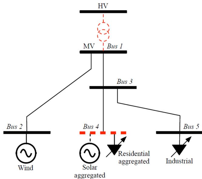
Un cas typique en Wallonie: Lorsque les sources d'énergie renouvelable (PV et éolien) produisent beaucoup d'électricité, des congestions peuvent apparaître au niveau du transformateur MT/HT et des surtensions au niveau du réseau basse tension (380 V). Cela implique des investissements importants.
