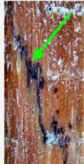
Lignes de démarcation noires dans le bois (formées par le champignon pour se protéger de la sécheresse et de la concurrence)
