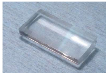
FIGURE 17.7 – Combinaison optique réseau/lentille réalisée durant le projet G2D. La lentille est en PMMA, le réseau de diffraction en NOA76 directement « imprimé » dessus.
