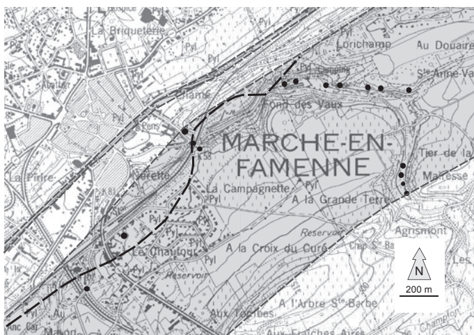
Fig. 15. Bande des calcaires dévoniens avec les différentes manifestations karstiques et l'accident majeur (Faille du Fond des Vaux) à Marche-en-Famenne.
