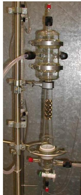
Abb. 18: Einzeltropfenmesszelle DN40 mit kleinem Packungselement
