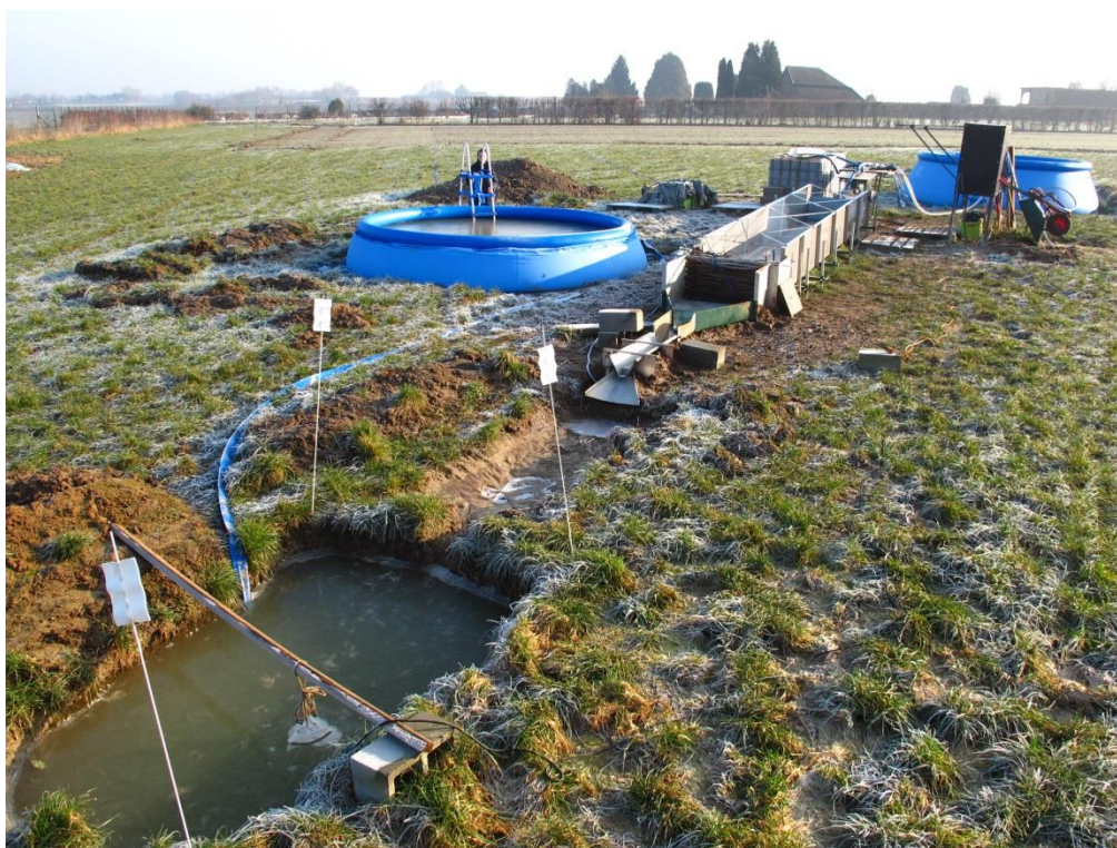
Figure 20. Simulateur de coulée de boue : schéma (haut) et photo (bas)
