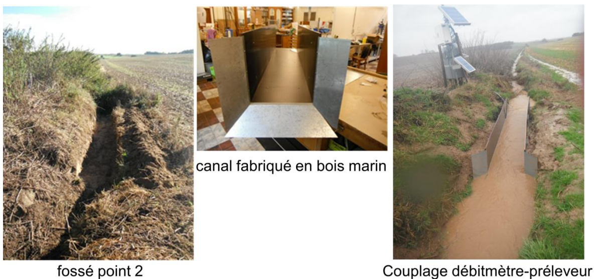
Figure 3. Point 2 : Débitmètre (Sonde hauteur/vitesse, OTT) + CR1000 + Echantillonneur (OTT)
