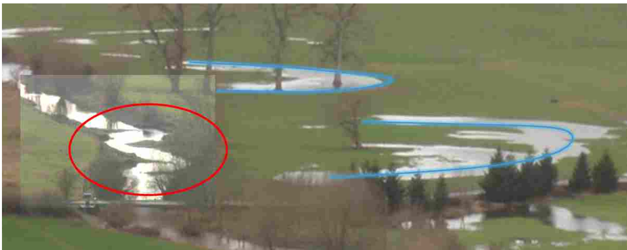
Figure 1: Photomontage de l'Eau Blanche à Nismes montrant le tracé des anciens méandres datant d'avant la rectification (trait bleu, photo de la décrue du 26/12/2012) et la reméandration secondaire réalisée dans le cadre des travaux de réhabilitation (rond rouge, photo du 23/03/2012 en basses eaux) (vue vers l'amont)
