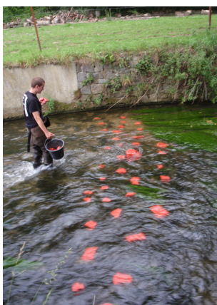
Photo 10: Mise en place du marquage sur la cunette bétonnée
