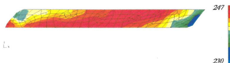
Fig. 5 – Courbes de niveau de \sigma_{xy} (MPa) dans l'éprouvette déformée à la fin du cycle.
