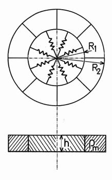
retenues par des ressorts, de manière à obtenir une raideur radiale donnée. Les masselotes sont idéalisées par une couronne sans raideur azimutale. Les données équivalentes sont
