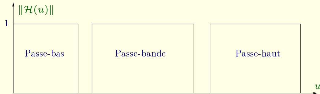
FIGURE 33: Filtres idéaux unidimensionnels.
