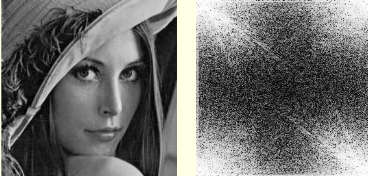
FIGURE 23: L'image Lena et le module de sa transformée de FOURIER discrète.
