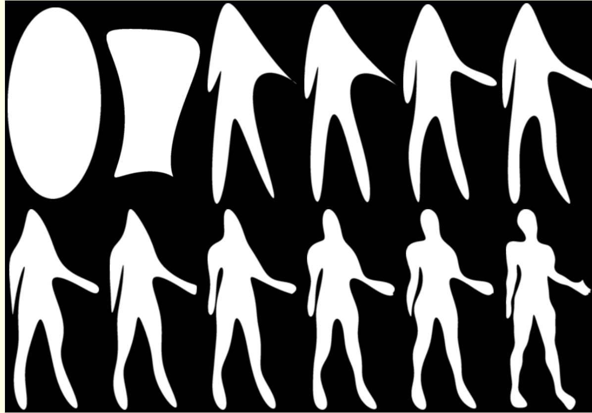
FIGURE 112: Forme originale et approximations du contour au moyen d'un nombre restreint de descripteurs de FOURIER.
