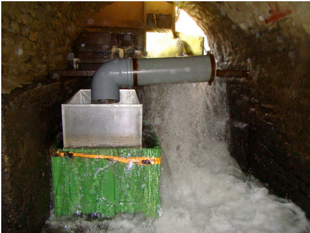
Figure 74. Le dispositif de piégeage à la dévalaison de Méry dans sa configuration en début 2012.
