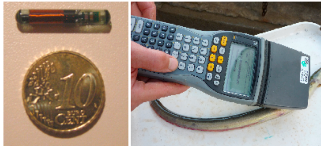
Figure 58. Transpondeur TIRIS (Texas Instrument) et lecteur de marque portable
