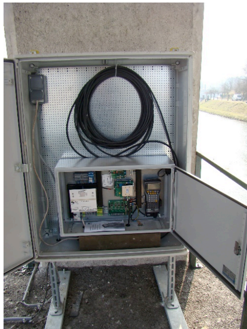
Figure 61. Au-dessus : antenne de détection RFID placée en 2012 au niveau d'une échancrure à l'amont de l'échelle à poissons du barrage des Grosses Battes sur la basse Ourthe à Liège. En dessous : station d'enregistrement des données logée dans une armoire métallique spécialement installée sur la pile du barrage mobile.
