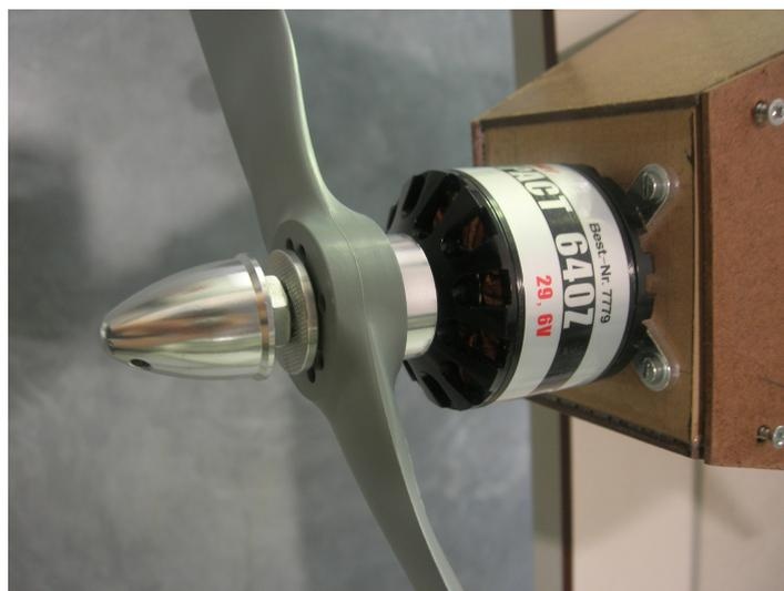
FIGURE 5.4 – Fixation de l'hélice sur le rotor du moteur
