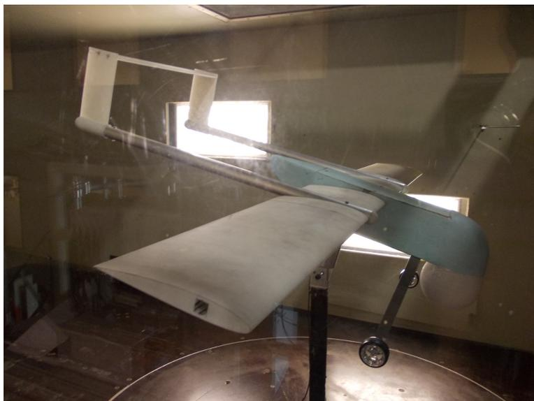
FIGURE 5.1 – Maquette à échelle 1/2 réalisée pour l'étude aérodynamique
