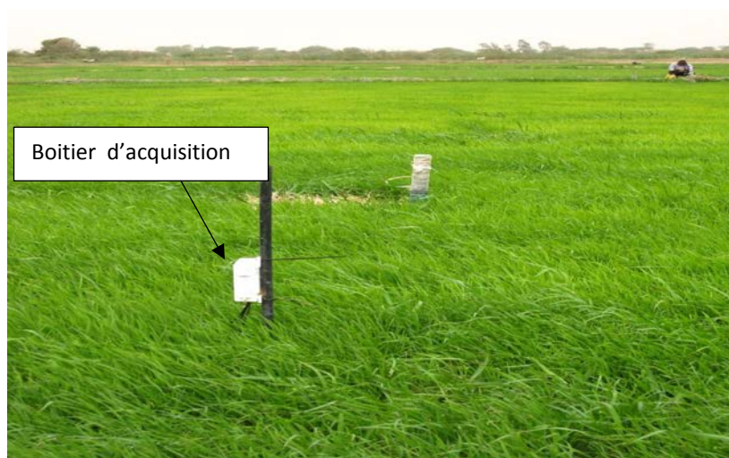
Figure IV-12 : Vue des sondes capacitatives mises en place sur le site de Ndelle
