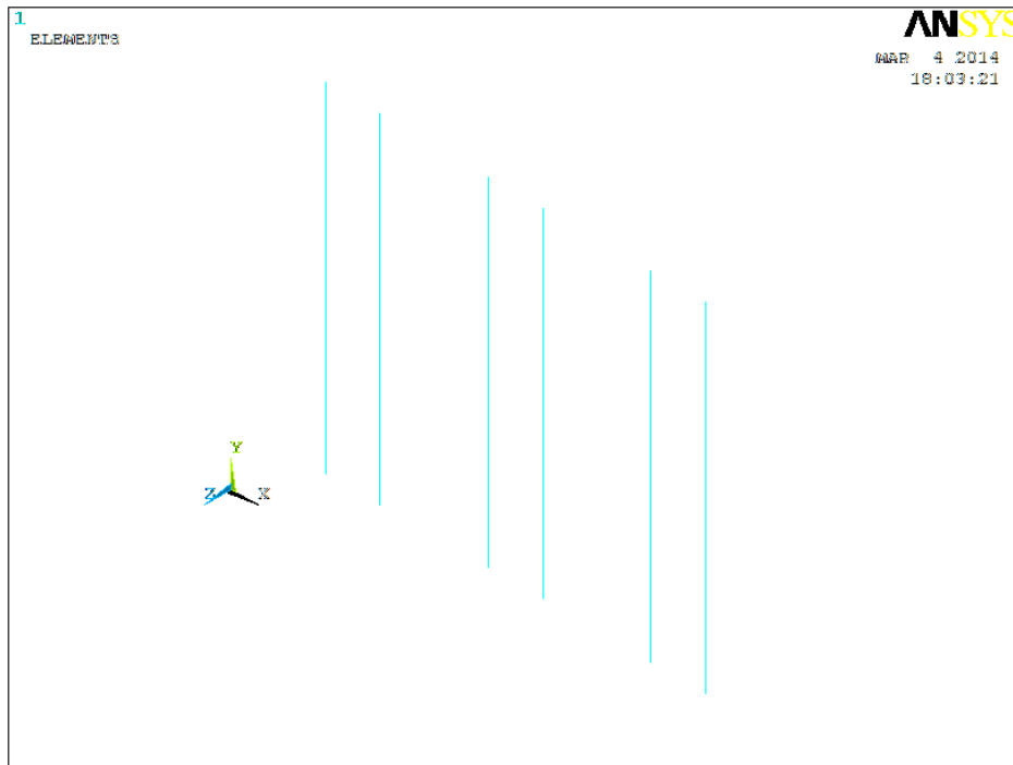
FIGURE 5.21 – Maillage en éléments poutre des raidisseurs
