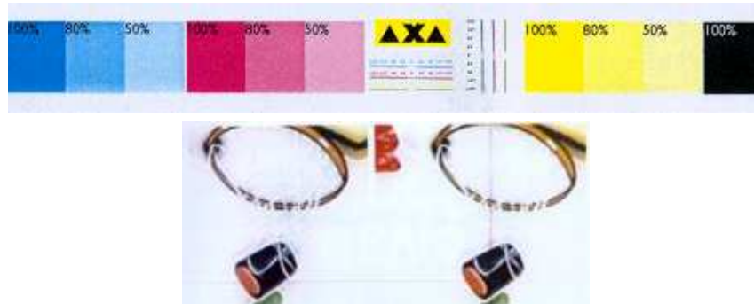
Figure 12.4: Imprimerie: mesure des couleurs, alignement des composantes, défauts d'encre, griffes des matrices.
