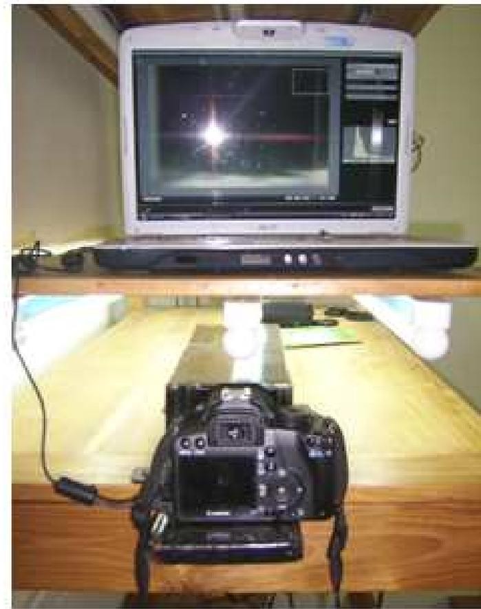
Photo 1 : Le dispositif de capture d'image
