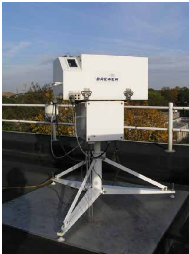
Figure 2 : Spectromètre Brewer sur le toit de l'IRM à Uccle.
