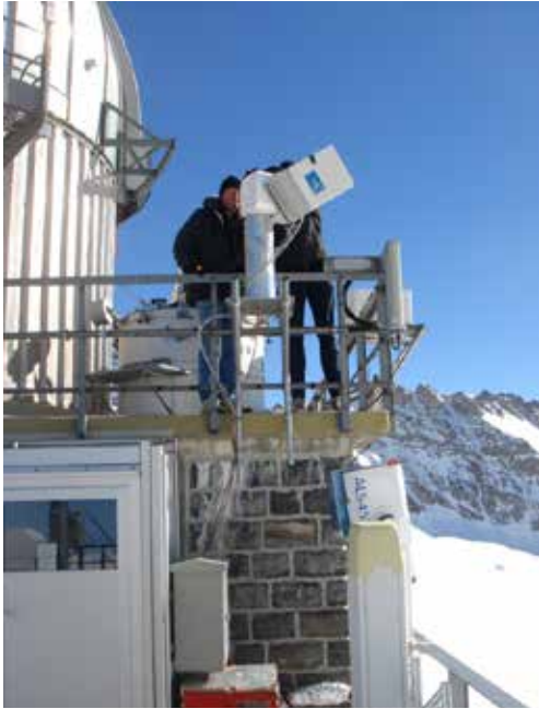
Figure 7 : Depuis 2010, l'IASB utilise l'instrument MAX-DOAS au Jungfraujoch. Sur cette image, les chercheurs Christian Hermans et Frederik Tack remplacent quelques éléments de l'instrument. © High Altitude Research Stations Jungfraujoch and Gornergrat
