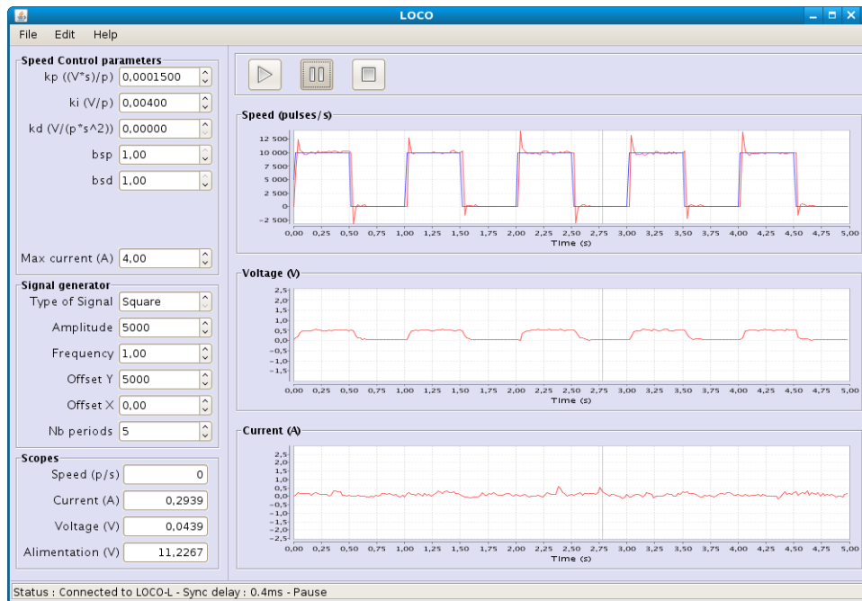
FIG. 5.1 – Vue d’ensemble de l’interface Java pour le réglage des paramètres de contrôle
