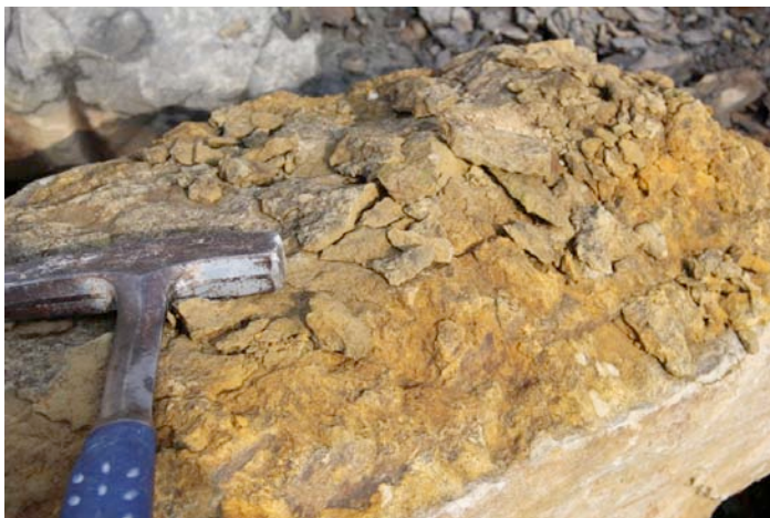
Banc de dolomie altérée à l'air formant un matériau ameubli jaune-orangé
