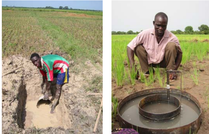
Foto 6.3 & 6.4 – Creuser d’un puit de profil (g.) et teste à double anneaux pour mesurer l’infiltration (d.)
