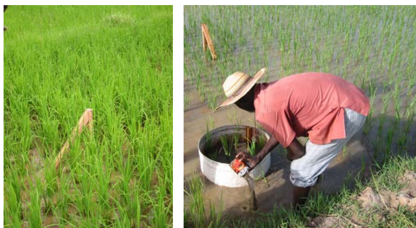
Foto 6.1 & 6.2 – Champ avec règle graduée (g.) et champ avec règle et lysimètre (d.)
