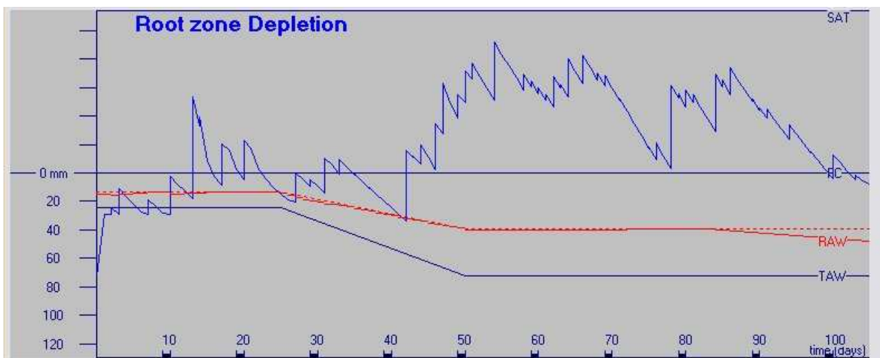
Figure 8.5 - Bilan d'eau simulé avec le logiciel BUDGET pour le champ du maïs pluvial avec tensiomètre 5
