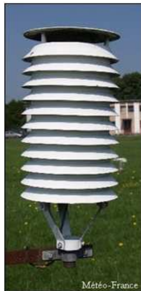
Figure 2.2 – Un abri récent à coupelles destiné à contenir des capteurs de type Pt100. [Météo-France]
