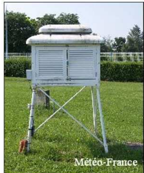
Figure 2.1 – Un abri ouvert sur la photographie de gauche, et un abri fermé, de type « Stevenson », sur la photo de droite. [Météo-France]
