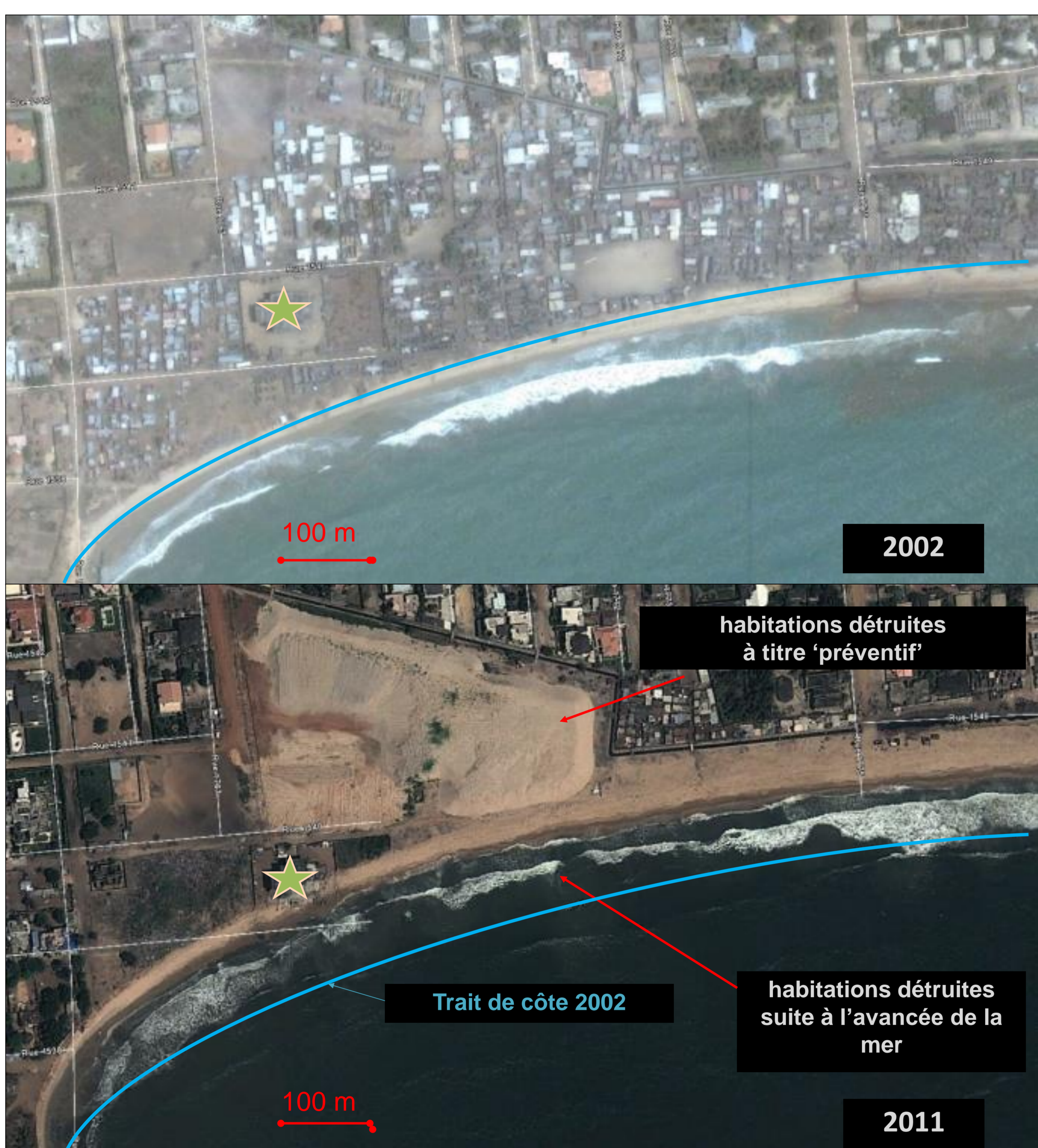
Figure 1: Images satellitaires disponibles sur Google Earth présentant les 800 premiers mètres à l'est de l'épi protégeant l'Hôtel Eldorado en 2002 et 2011. L'étoile positionne le bâtiment présenté à la Fig. 2.
