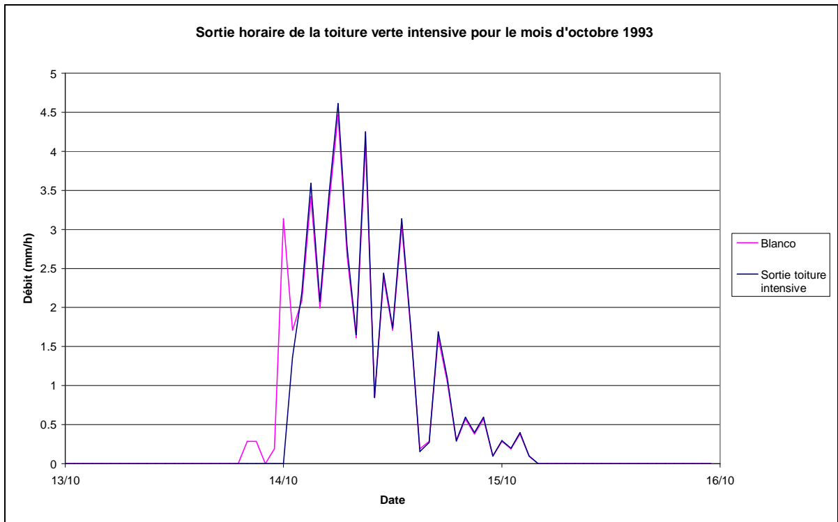
Figure 44 : Comparaison entre les sorties du Blanco et de la toiture verte intensive (octobre 1993).
