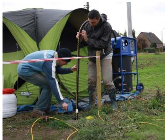
Figure 3 – Injection simultanée d'eau chaude et de traceur. L'eau chaude est produite par la chaudière de terrain portative (en bleu sur la photo).
