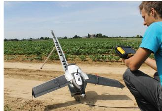
FIGURE 2: Mise en place du drone Gatewing X100. L'endurance de vol est de 40 minutes avec une vitesse croisière de 80 km/h, permettant le survol de 100 ha avec un recouvrement longitudinal et latéral de 80% à 250 m d'altitude (résolution de 8.5 cm).
