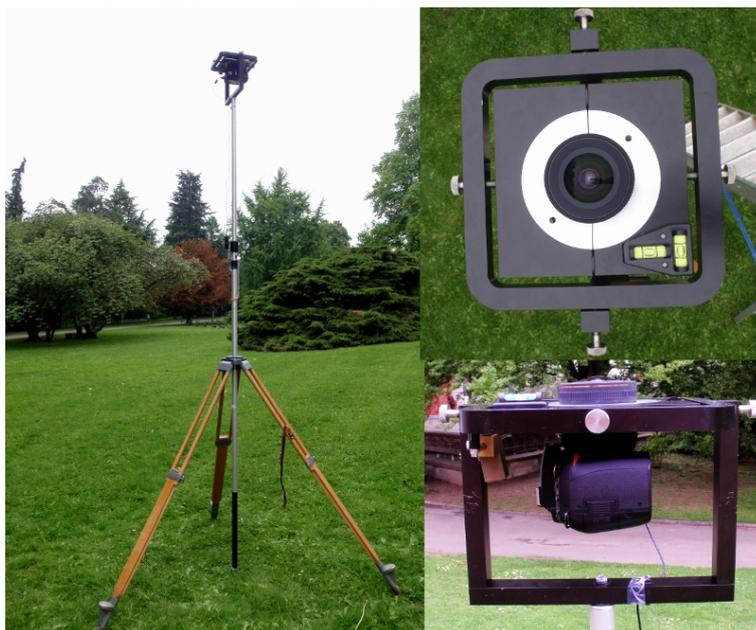
**Figure 2:** Trépied utilisé pour l’obtention de photographies hémisphériques
