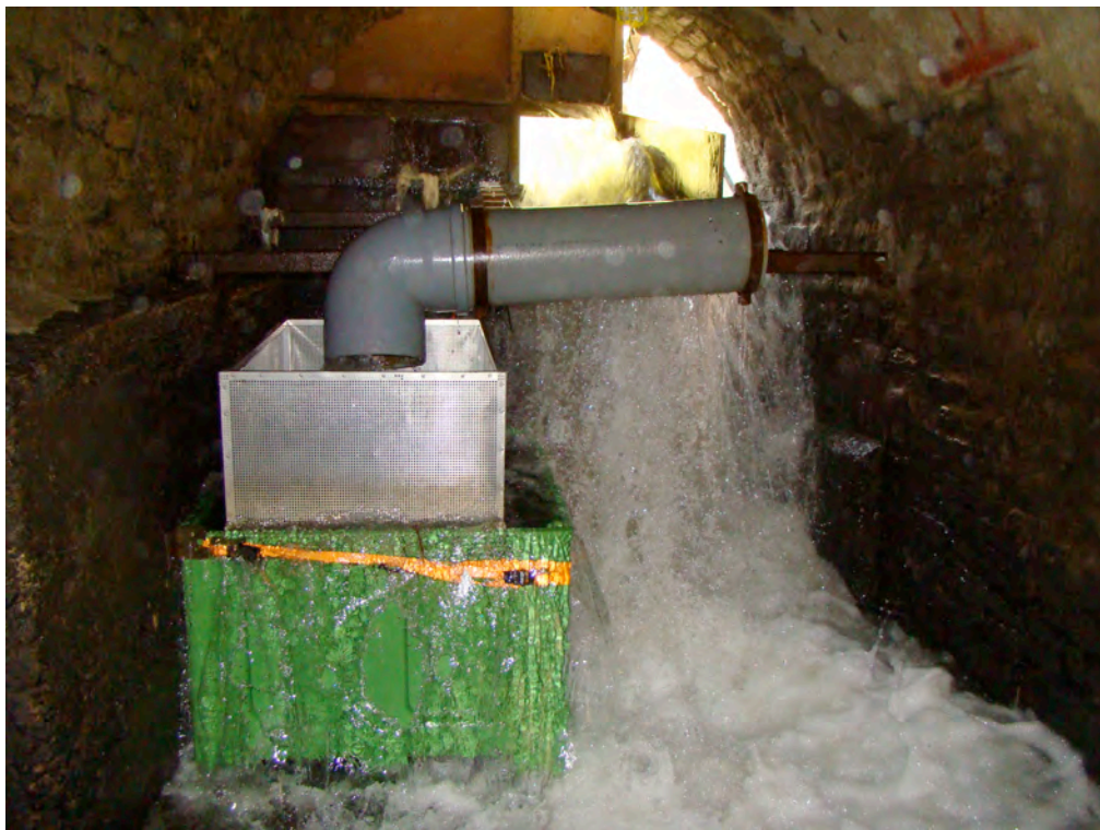
Figure 88 b. Le dispositif de piégeage à la dévalaison de Méry dans sa configuration en début 2012.
