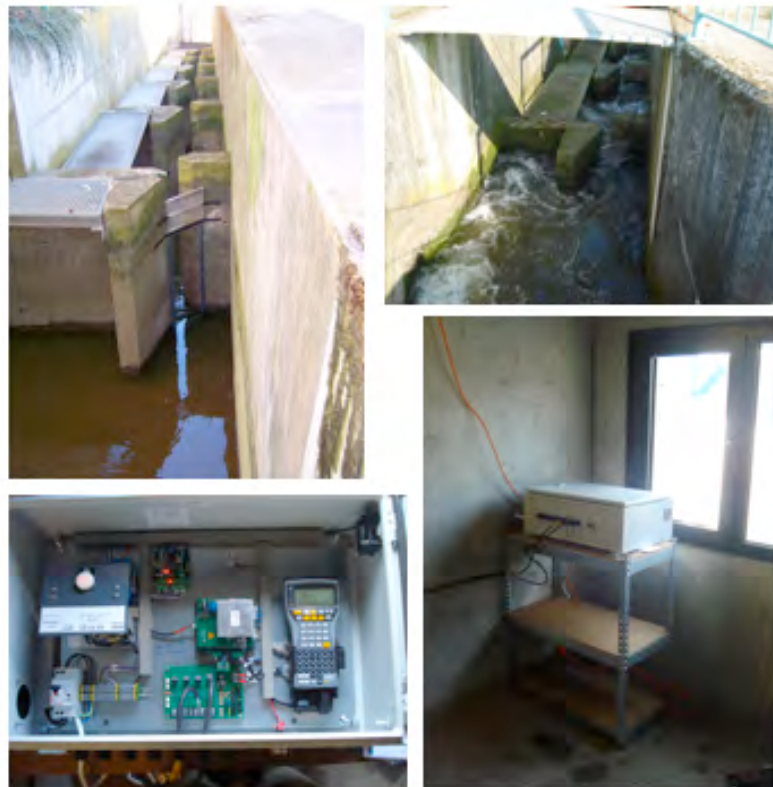
Figure 77. Détecteur CIPAM de poissons pucés installé en 2011 dans la passe à bassins du barrage d'Ivoz-Ramet sur la Meuse (km 97,1). Au-dessus : antenne de détection placée sur la fente du bassin supérieur à sec (à gauche) et sous eau (à droite). En-dessous : boîtier électronique (à gauche) abrité dans un local du barrage+centrale hydroélectrique (à droite).
