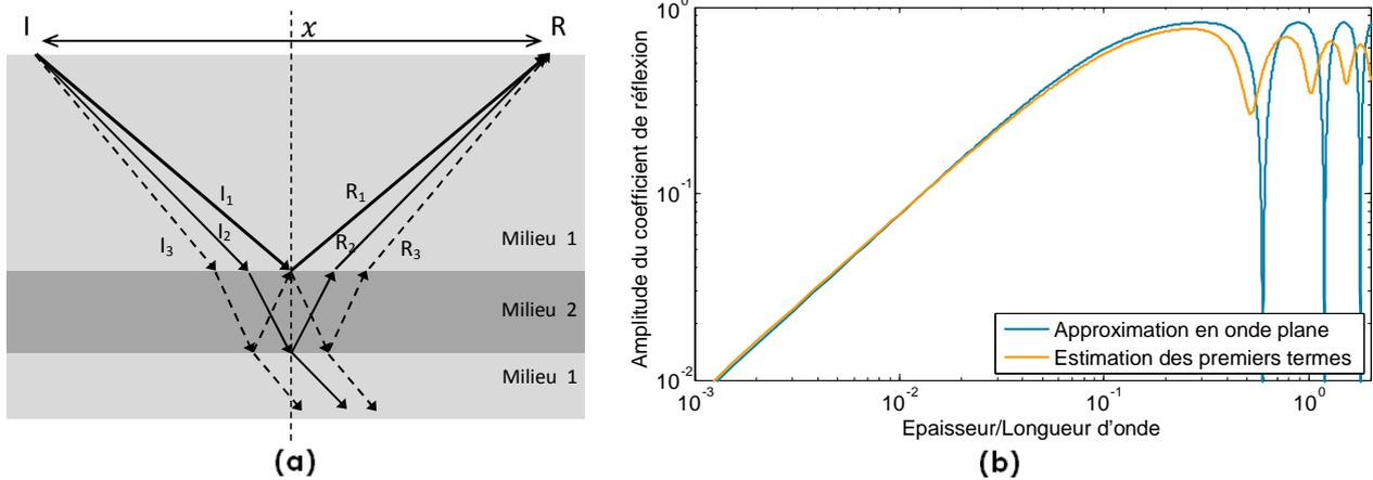
**Figure 2. (a) Variation de l'inclinaison des différents multiples lorsque la couche est peu profonde ; (b) coefficient de réflexion en fonction du rapport (épaisseur / longueur d'onde).**
