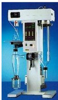
Figure 4 - 16 : Photo de l'atomiseur Buchi B-191 présent au laboratoire.
