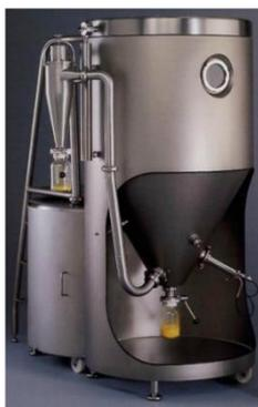
Figure 4 - 35 : Photo de l'atomiseur GEA Niro Mobile Minor.
