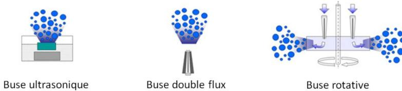
Figure 4 - 3 : Schéma de différents types d'atomiseur utilisés pour la technique de séchage par atomisation.
