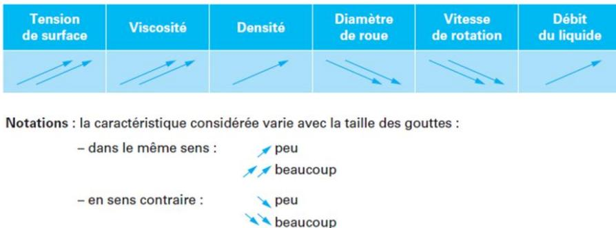
Figure 4 - 5 : Influence des caractéristiques du liquide, des caractéristiques des turbines et des conditions opératoires sur la taille de la goutte [3].
