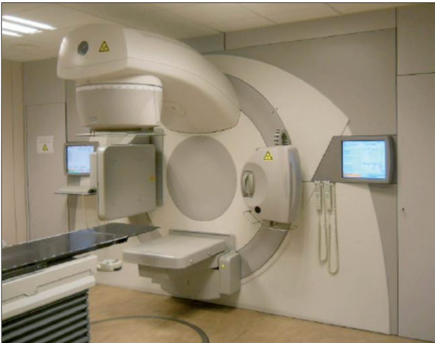
Figure 2. Accélérateur linéaire doté d'un système d'imagerie embarqué permettant d'obtenir des images planaires (2D) ou, en utilisant la technique dite du Cone beam CT, des images volumiques (3D).
