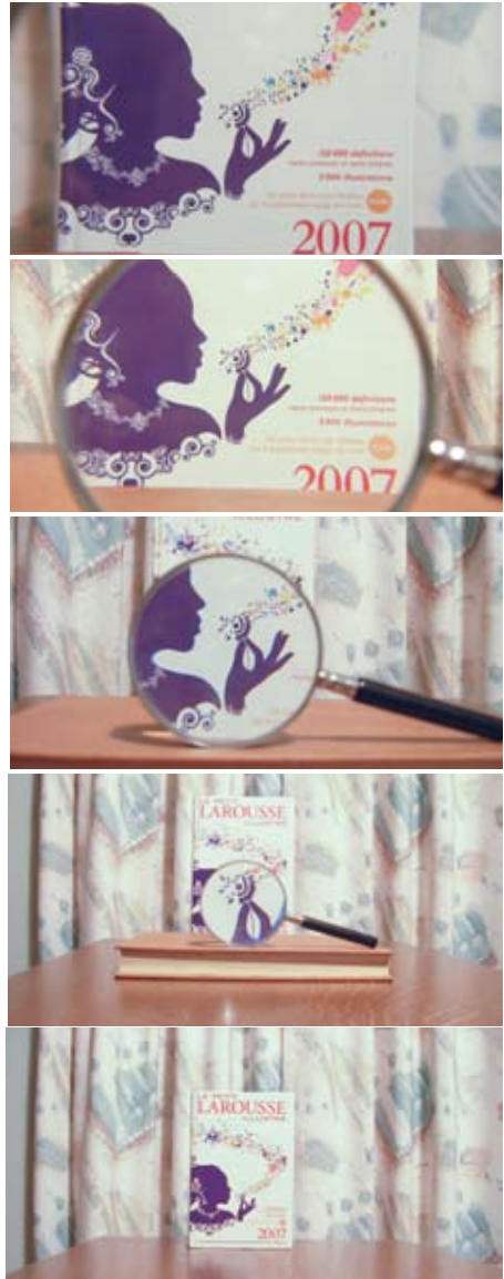
Le Petit Larousse vu à la loupe. Le livre est placé au foyer de la lentille. En haut, l'œil est contre celle-ci. L'aspect serait le même s'il n'y avait pas de loupe mais, pour percevoir l'image avec netteté, il faudrait être capable d'accommoder à 25 cm plutôt qu'à l'infini. En reculant, les dimensions apparentes des choses vues au travers de la loupe ne changent pas alors que le champ se réduit.
