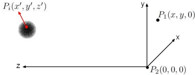
FIGURE 2.6 – Schématisation d'une source étendue située loin du plan d'observation
