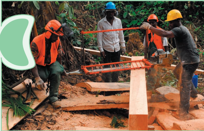
Utilisation d'une gruminette pour débiter des planches calibrées pour la construction
