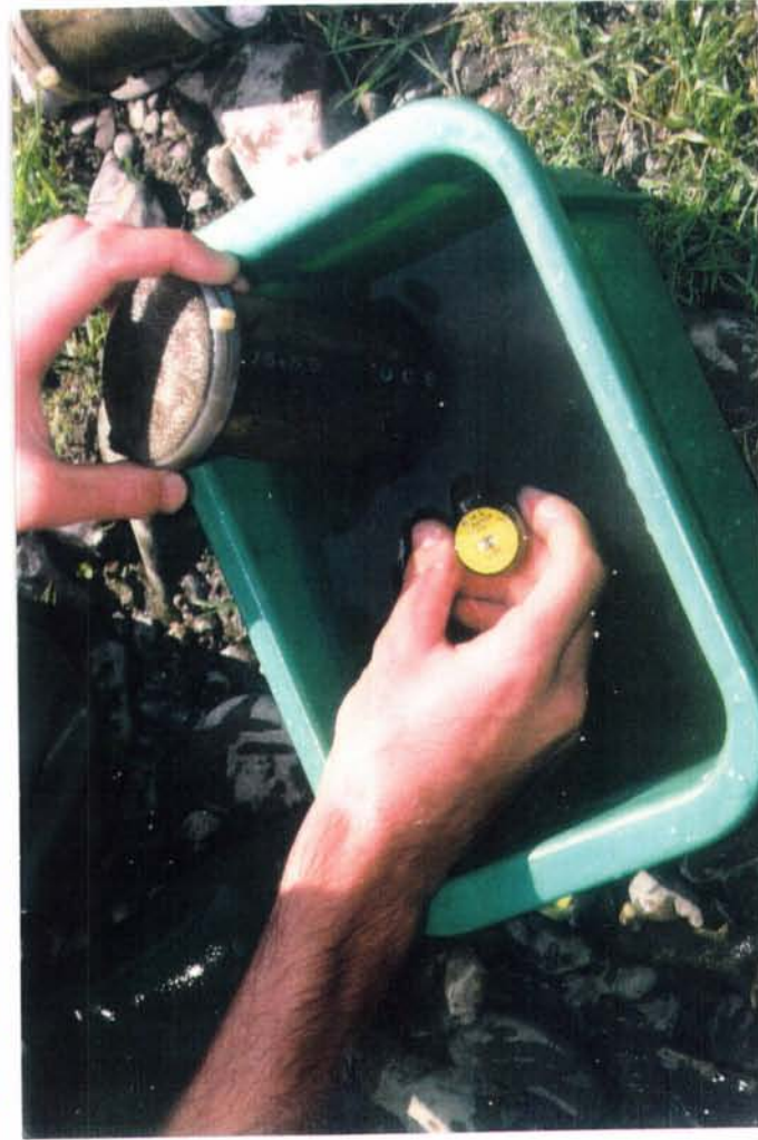
Photo 1. Tube réservoir d'eau interstitielle enfouis dans le gravier à côté des incubateurs artificiels d'oeufs.
