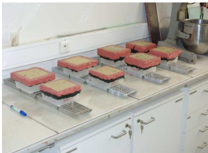
Figure 4. Essais de perméabilité à la vapeur sur enduits
