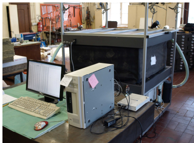
Figure 6. Plaque chaude gardée à une éprouvette
