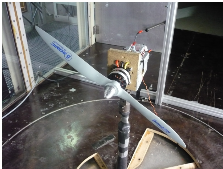
FIGURE 4.2 – Illustration du moteur et de son hélice, en configuration tirante, dans la soufflerie de l'ULg.
