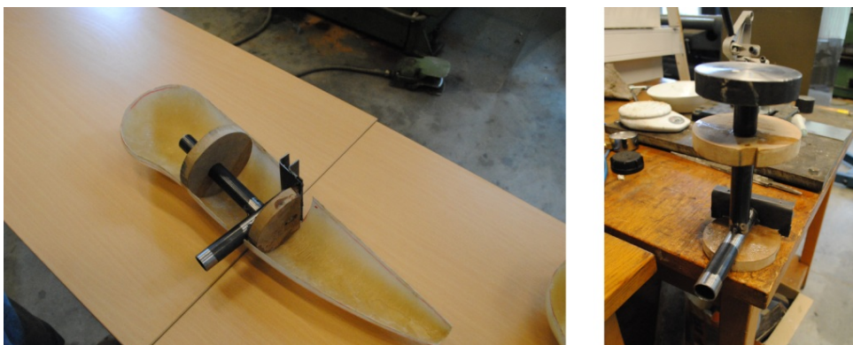
FIGURE 3.11 – Support permettant la fixation de la maquette complète à l'échelle 1:2 au mât de la soufflerie.
