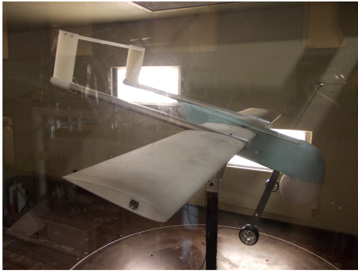
FIGURE 2.1 – Illustration de la maquette 2010 (échelle 1:2).
