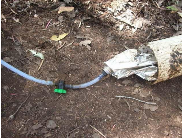
Figure 4: dispositif groupé sac collecteur – abri – et tube de connexion
