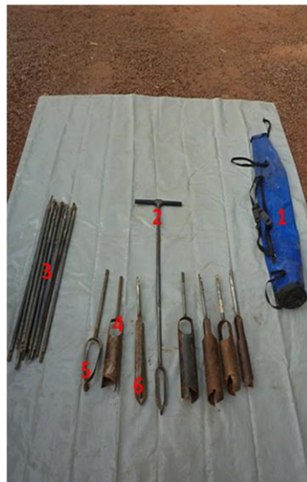
Figure 1 : Equipement de tarière combinée : 1) Sac de transport, 2) Tige à poignée, 3) Tiges de rallonges, 4) Soupape (tête coupante) Soft, 5) Soupape Edelman, 6) Soupape Riverside
