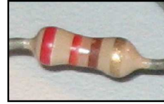
Photo II.9. : Résistance utilisée = 220 \Omega \pm 5 \%
