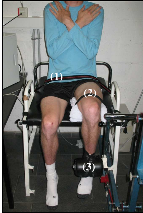
Photo II.4. : Réglage de la position du sujet avec sanglages à trois niveaux
