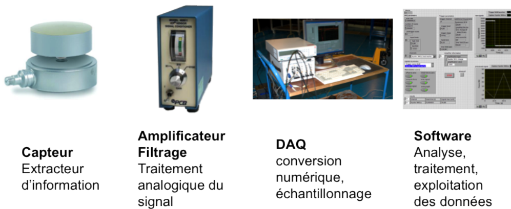
FIGURE 4.13. Une chaîne de mesure typique employée pour ce doctorat.
