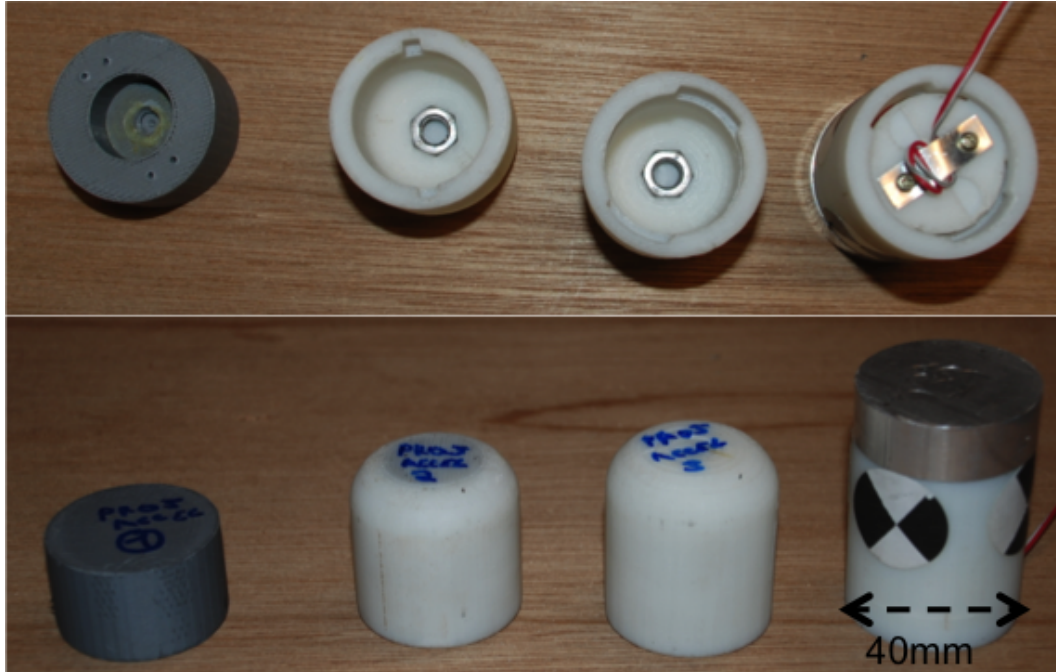
FIGURE G.3. Les différentes versions du projectile instrumenté, les versions évoluant de gauche vers la droite. En haut, une vue du haut, avec l'accéléromètre vissé au centre, caché pour le projectile final. En bas, vue latérale, avec présence d'un palet en aluminium pour le projectile final.
