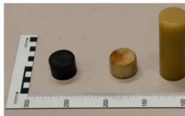
FIGURE 2.5. Des projectiles bâton, de 37 mm. A gauche, un projectile en caoutchouc de 28 g, au milieu un projectile en bois de 32 g, à droite un projectile en plastique de 134 g (le L5).
