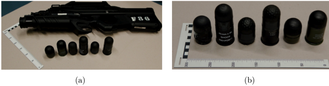
FIGURE 2.2. (a) Le lanceur F2000 équipé d'un lance grenade 40 mm. (b) Quelques projectiles 40mm. De gauche à droite, le Nobel Sport Spartan LE-40, le même dans sa cartouche, le Brügger et Thomet Sir-X, le même dans sa cartouche et le Rheinmetall Nico Pyrotechnik Impulse Nic, et le même dans sa cartouche.
