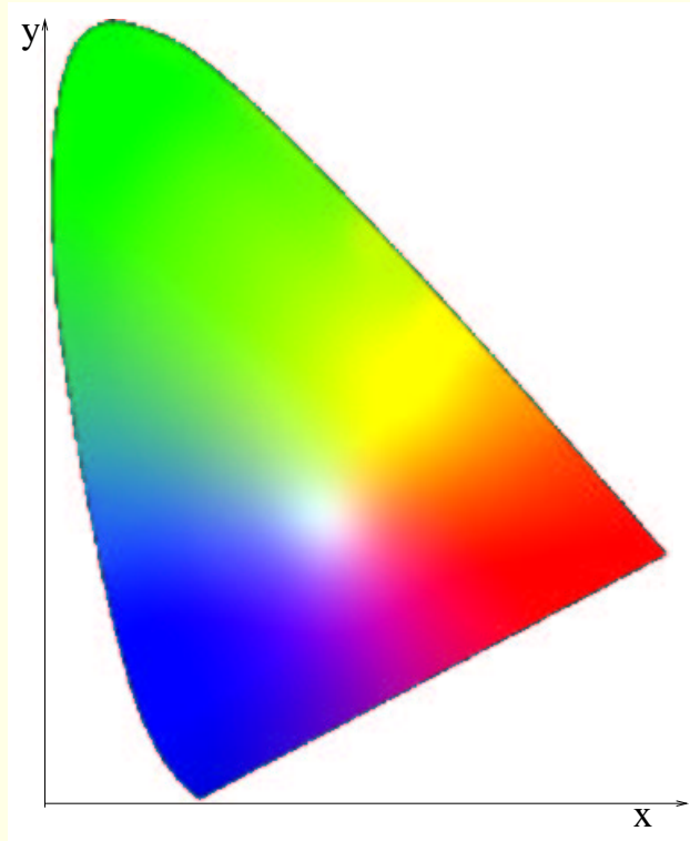
FIG. 8: Diagramme chromatique (approché!) défini par les deux variables de chrominance x et y .
