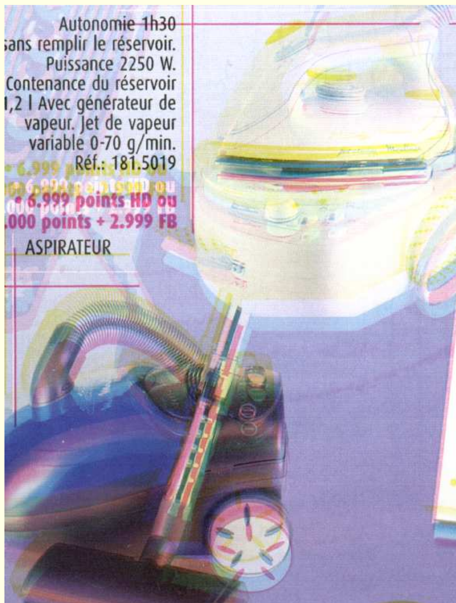
FIG. 2.14 – Défaut d'alignement des couleurs d'impression permettant de voir les 3 composantes de couleur CMY et la composante noire K.
