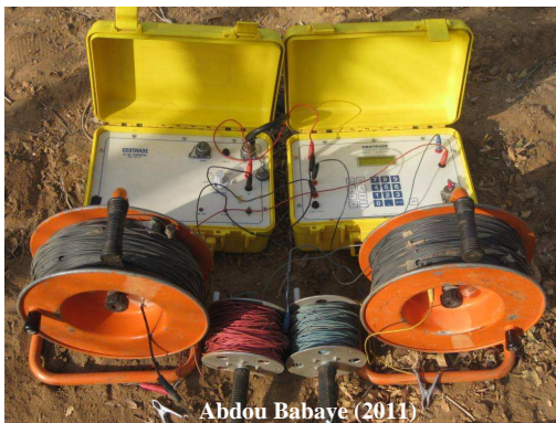
Photo 13 : Résistivimètre GTR-2, fils A-B et MN. Photo 14 : Mesure des anomalies sur le terrain.
