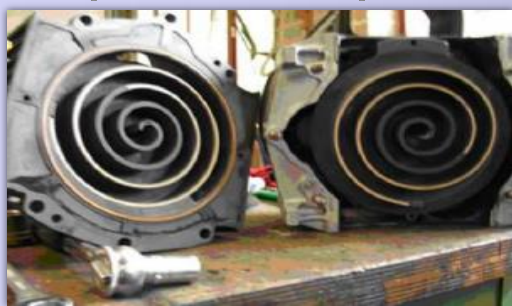
Compresseur scroll modifié en expanseur scroll
