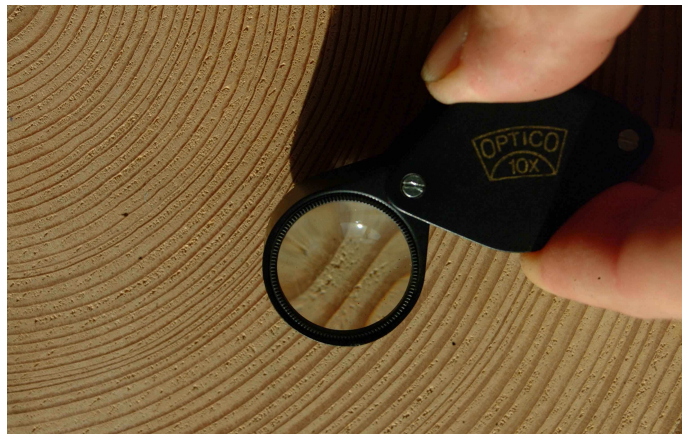
Figure 1 : Observation à l'œil nu et à la loupe (grossissement 10x) de la face transversale d'un épicéa commun, montrant le bois de printemps et le bois d'été à l'intérieur des cernes annuels.
