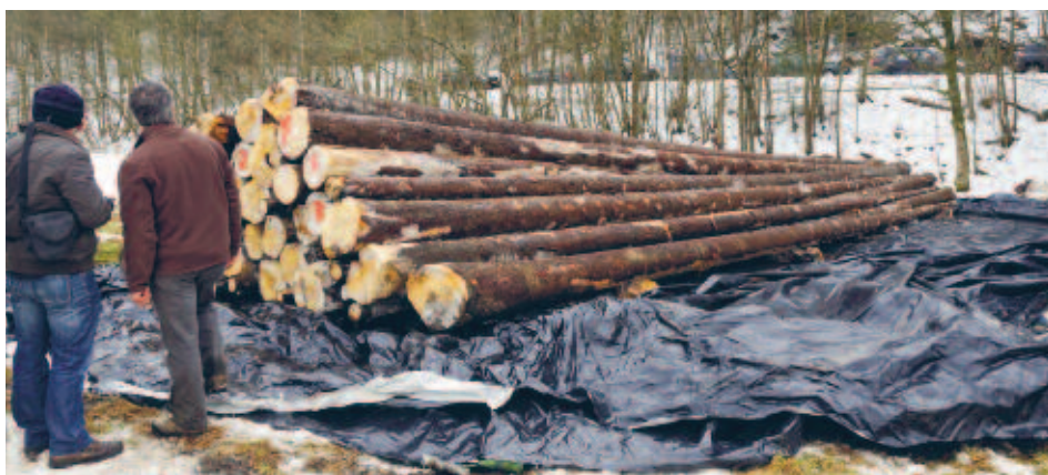
1742 jours plus tard, le bois n'a pas bougé. Juste un peu d'eau sous le paquet et une moisissure superficielle et éparse.
