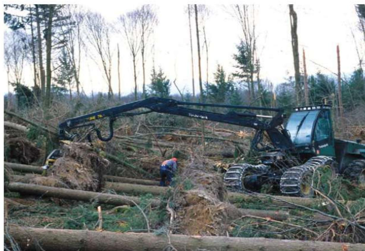
*La machine de bûcheronnage maintient la grume pour sécuriser la phase de découpe du bois en tension*
