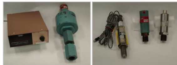
Figure 12 : Jauge piézorésistive de manganin (gauche) et capteur de pression piézorésistif (droite)
