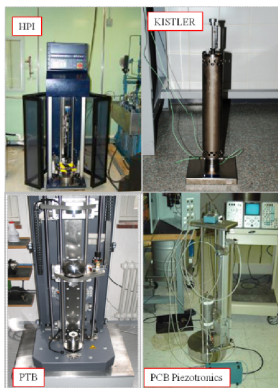
Figure 13 : Générateurs d'impulsions de pression
