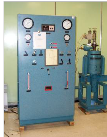
Figure 11 : Générateur dynamique de pression type Harwood
