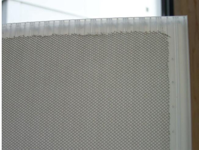
**Abbildung 4.2: Aufnahme einer Polypropylen-Doppelstapplatte mit Vlies beschichtet**
