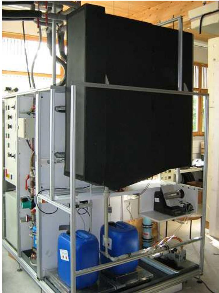
**Abbildung 7.1: Aufnahme des neuen Monokanals, der im Kreuzstrom und mit hohem Solemassenstrom betrieben wird**
