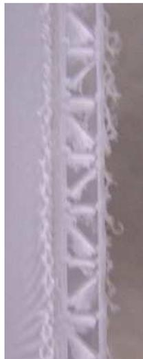
**Abbildung 4.1: Doppelstegstruktur der Austauschplatten.**
