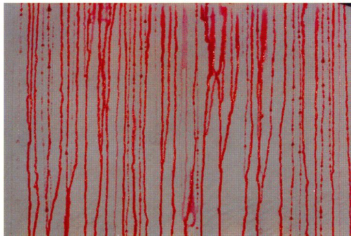
**Abbildung 4.3: Bildung von Kanälen beim Soleströmen auf Polypropylenplatten, die mit einem Vlies beschichtet sind**
