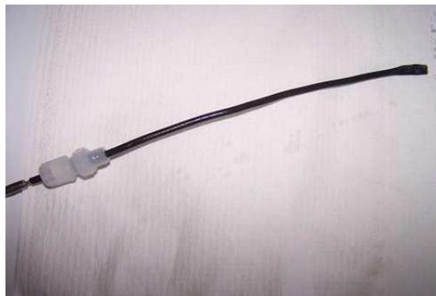
**Abbildung 6.3: Aufnahme eines Pt100 Temperaturfühlers mit einem Schrumpfschlauch beschichtet**
