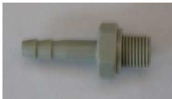
**Abbildung 4.8: Aufnahme der Eintrittsstülle für das Soleeinströmen in den Verteiler**
